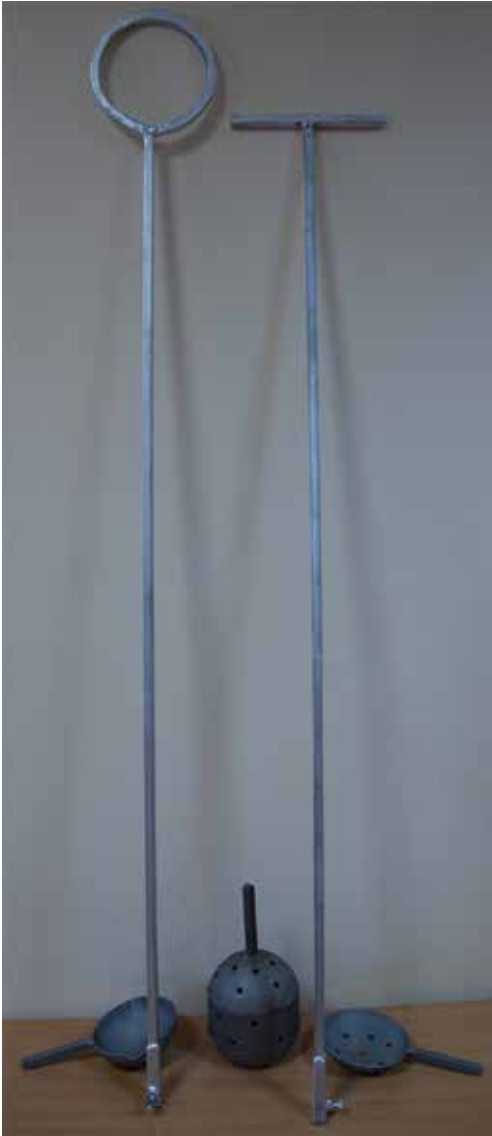
Рукоятки, соединение “под винт”
