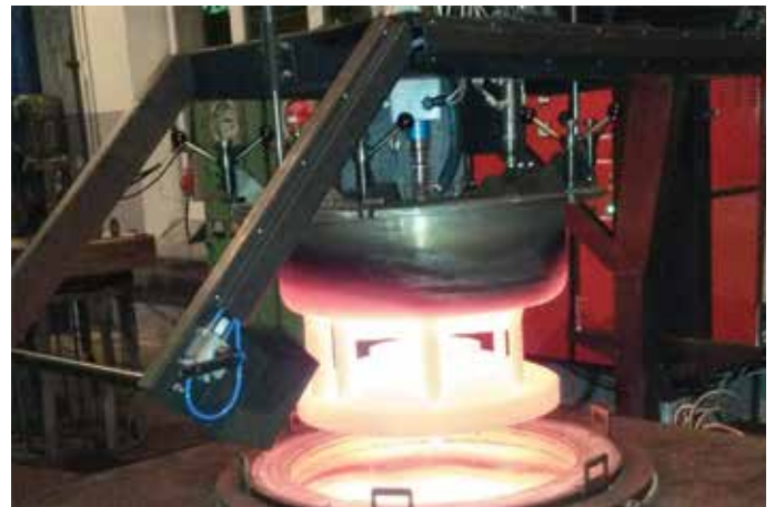
Шахтная печь с газоплотной ретортой и циркуляцией атмосферы для термической и химико-термической обработки металлов в защитной атмосфере
