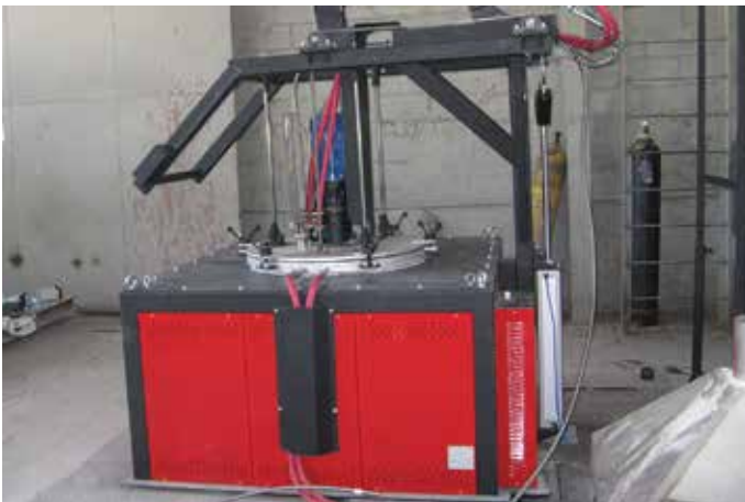
Шахтная печь с газоплотной ретортой и циркуляцией атмосферы для термической и химико-термической обработки металлов в защитной атмосфере
